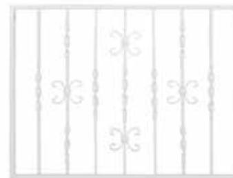
Indicación sobre el montaje: Al montar la reja de ventana en la pared, dicha reja debe tener la anchura mínima necesaria para que los orificios de fijación estén separados 80 mm del intradós de la ventana. De lo contrario, la mampostería puede romperse.
