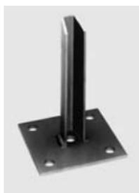
Mit Pfostenfüßen sind Zaunpfähle auf Mauern ganz einfach zu montieren. Die Pfostenfüße werden auf die Mauer gedübelt, die Zaunpfähle kurz unterhalb des unteren Spanndrahtalters abgeschnitten und auf die Pfostenfüße montiert.
